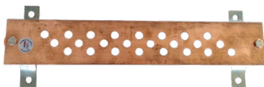
CÓDIGO DESCRIÇÃO Tel 936 BEP/BEL 76,2 x 6,35 x 360mm 24 furos Ø 11,1mm
