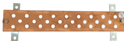
CÓDIGO DESCRIÇÃO Tel 935 BEP/BEL 101,2 x 6,35 x 385mm 26 furos Ø 12mm
