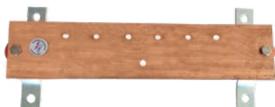
CÓDIGO DESCRIÇÃO Tel 930 BEP/BEL 63,5 x 6,35 x 300mm 7 furos Ø 6,35mm
